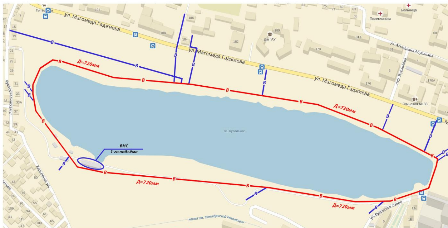
Схема ВС Мероприятия № 3 «Проектирование и реконструкция кольцевого водовода вузовского озера Д=720 мм из стальных труб протяженностью 3,0 км»
